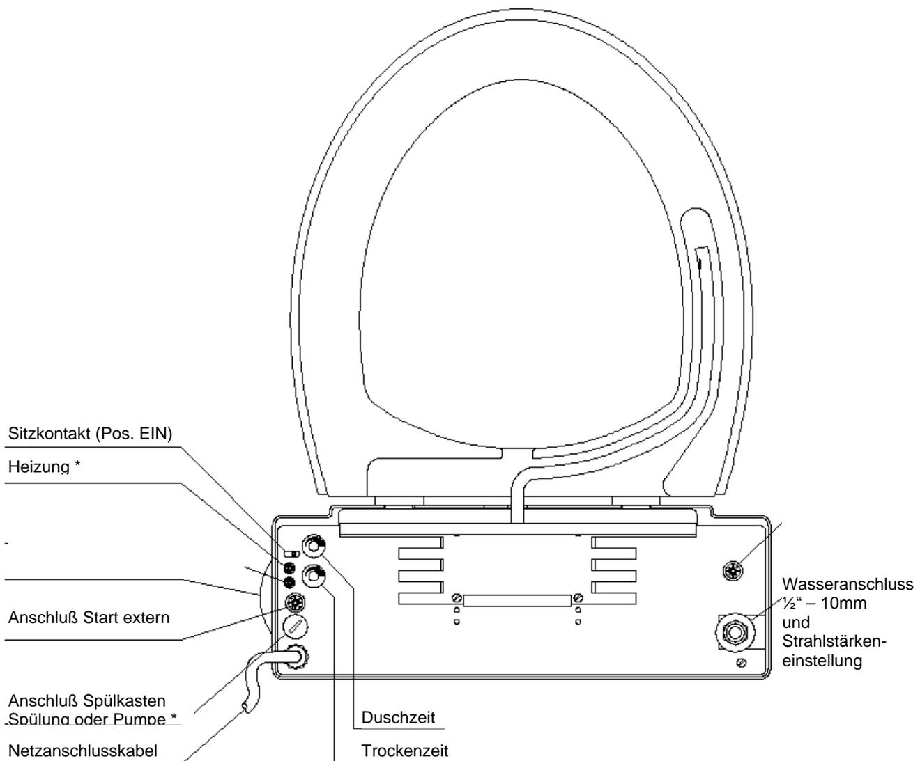
Die vorstehend gezeigten Einstellmöglichkeiten sind lediglich mögliche Voreinstellungen nach Kundenwunsch und haben mit der Bedienung des VAmat nichts zu tun. **Für die Bedienung** wird lediglich **eine Starttaste benötigt**. Diese befindet sich serienmäßig am Gehäuse. Es können auch andere Startmöglichkeiten als Option gewählt werden!
